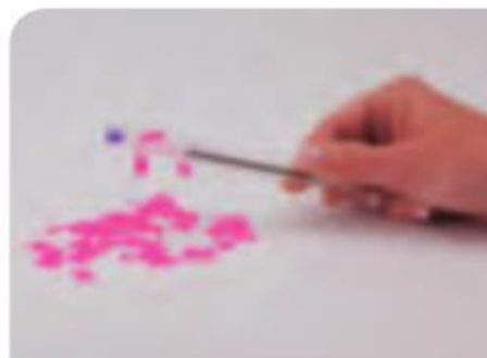
1 Un bolígraf de plàstic atrau trossets de paper quan s'electritza. És un exemple d'electricitat estàtica.
